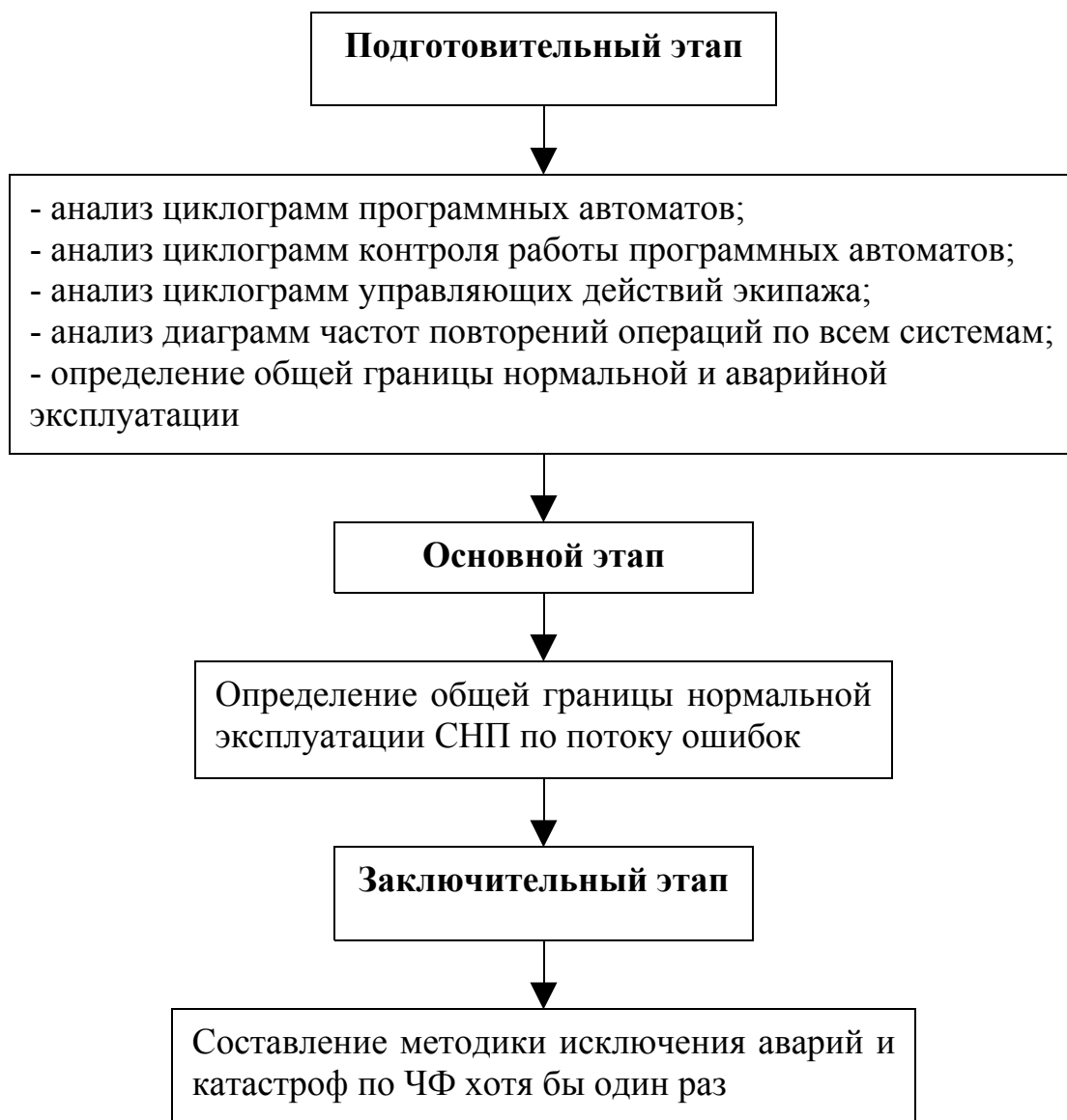
Рис. 2. Структура методики процессного анализа потоков ошибок экипажей СНП
